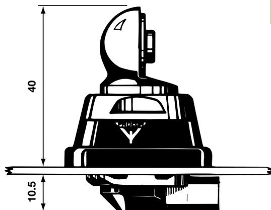
Verwenden Sie KEINE zusätzlichen Dichtungsmittel zur Montage.
